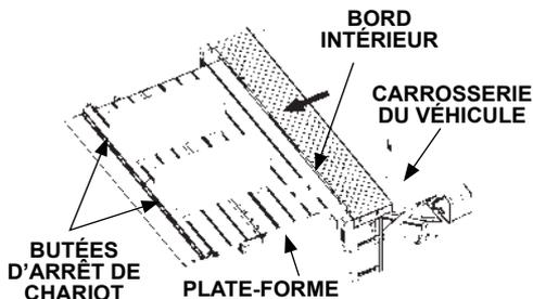
**CHARGER LA PLATE-FORME À HAUTEUR DE PLANCHER (BUTÉES D'ARRÊT DOUBLES OUVERTES)**
