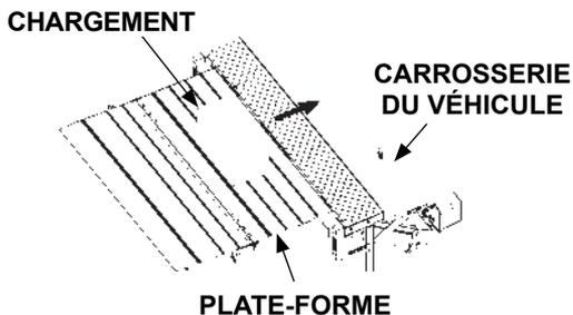
**DÉCHARGER LA PLATE-FORME À HAUTEUR DE PLANCHER**
